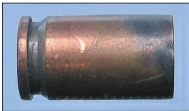
Slika 5: Trag okvira za municiju na čahuri
